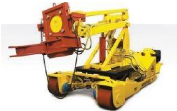
ماژول (واحد) MSC-6 برای انجام عملیات نصب و پیاده سازی جک های بالابر اتاق بار ، جک های تعلیق و میله های نگهدارنده توپی چرخ ، بر روی یک نگهدارنده MDG-240C نصب می شود.
